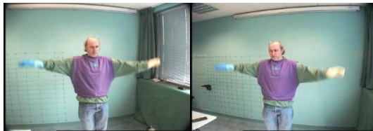
FIG. 3 – Images droite et gauche d'une personne présentant une extension maximale des bras. Les deux caméras avec un champ de 70° sont à 1,60m du sol et distantes de 1,20 m ; la personne est située à 1,90 m des deux caméras.
