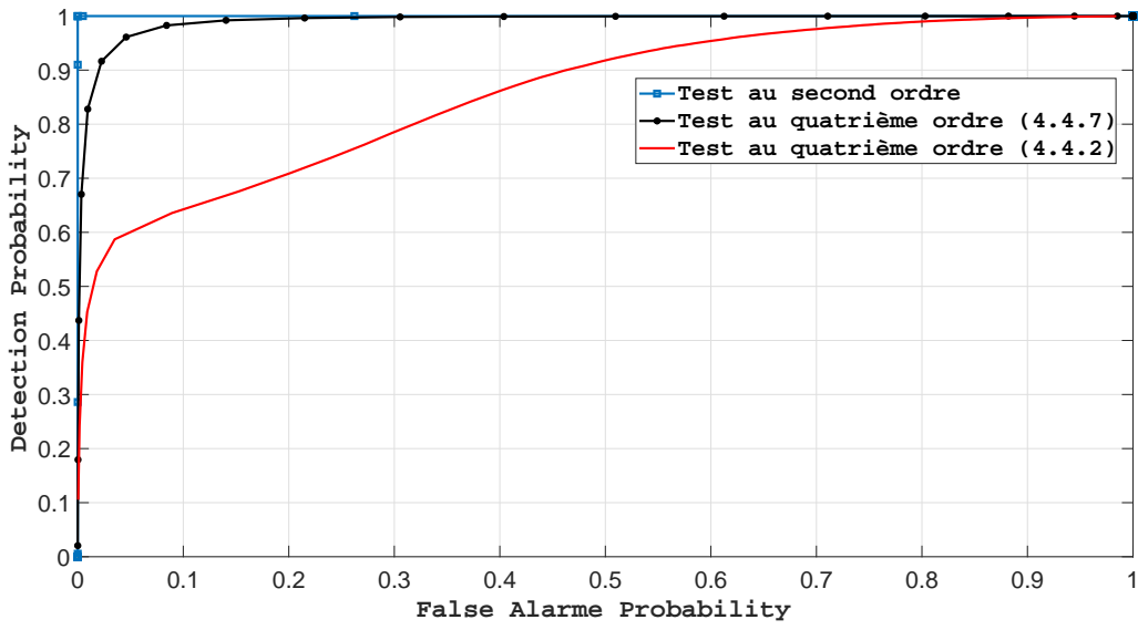
FIGURE 4.5 – Courbes ROC pour SNR = -3dB et K = 1000
