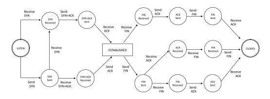
Fig. 1. TCP state automaton.
